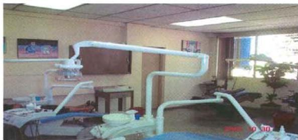
El equipo dental no se ha revestido con material de polipropileno, que impida la acumulación de bacterias.
